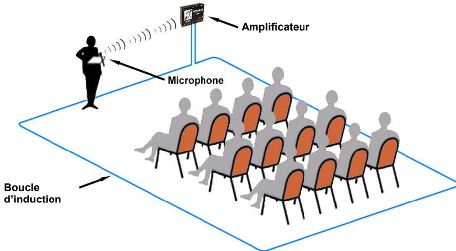
Les systèmes de boucle magnétique sont destinés à fonctionner en complément d'appareils d'assistance à l'audition muni de la position « T ». Dans ce cas, le capteur de l'appareil est désactivé, et l'appareil ne reçoit que les sons transmis par la boucle magnétique.
